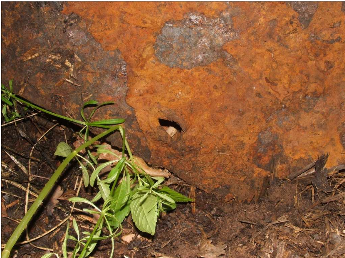
Teil der Turmschürze des Panzer III mit Einschussloch
